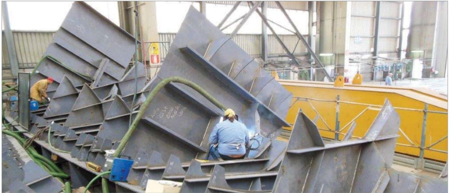
Travailleurs du chantier naval Castellammare di Stabia (Fincantieri), en Italie, inspectant une section à l'avant du futur navire. Cette partie est renforcée pour accueillir les réservoirs de gaz naturel liquéfié (GNL). PHOTO COURTOISIE
