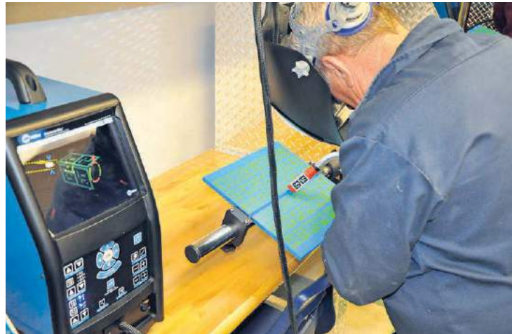
La soudeuse intelligente (à gauche) enregistre tous les paramètres de la soudure et évalue en temps réel le mouvement des apprentis. (Photo Le Pharillon – Jean-Philippe Thibault)
